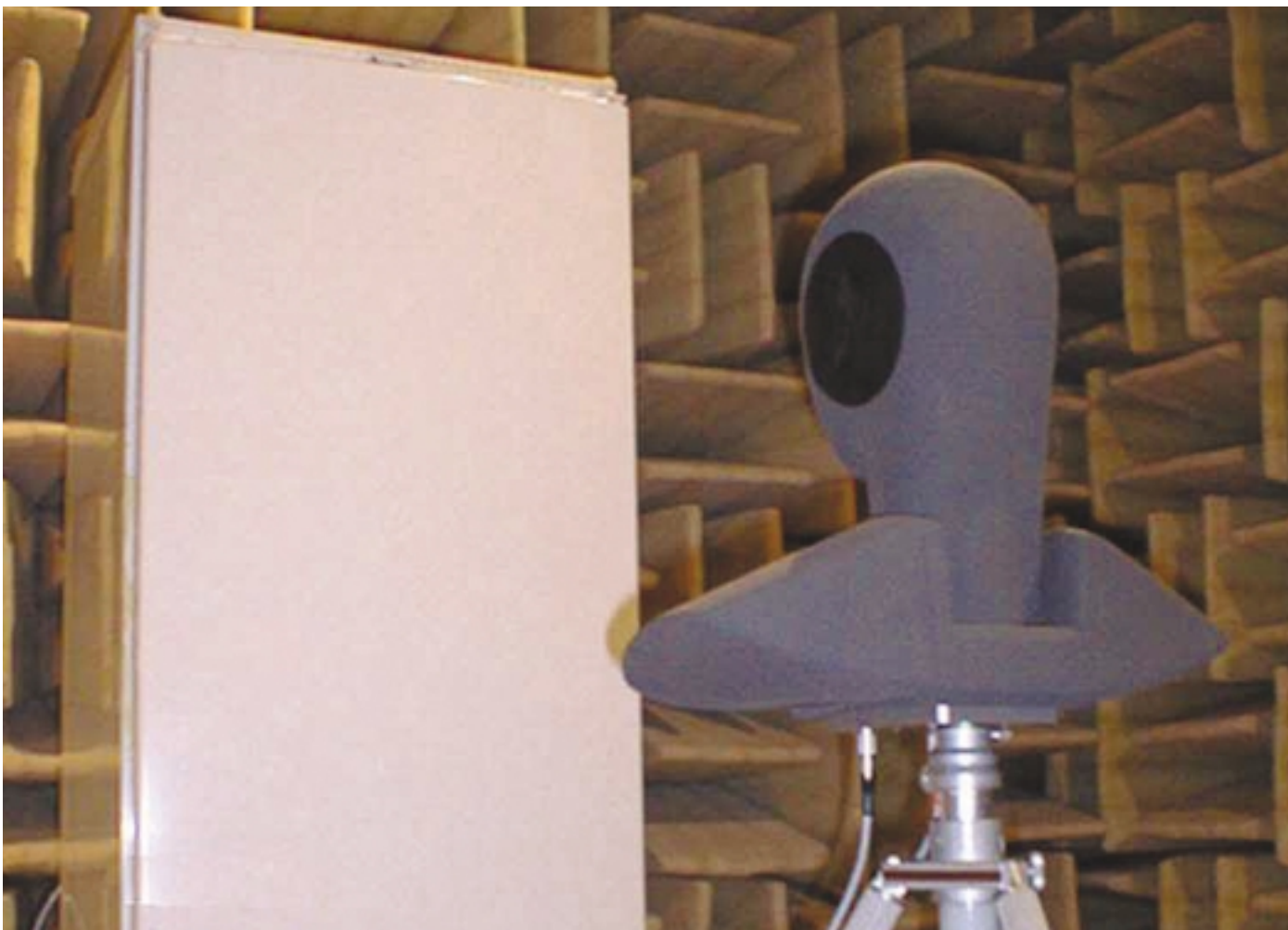
Abb. 4: Schallmessung im reflexionsarmen Raum Fig. 4: Test setup in the anechoic room
